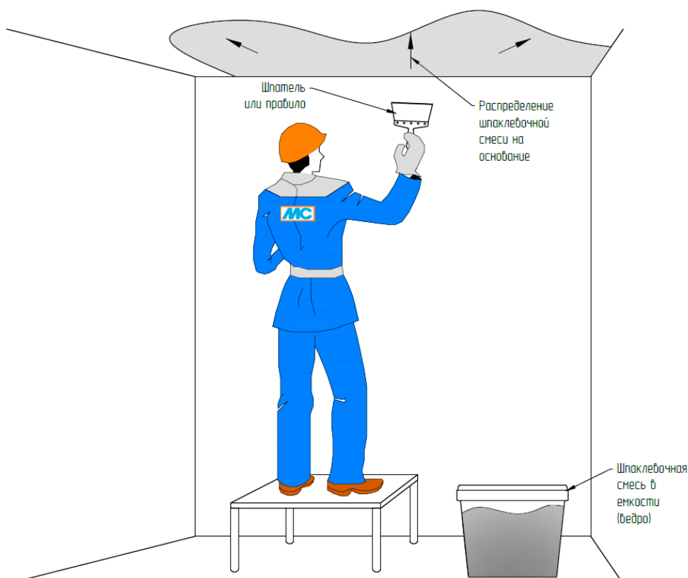
Рис. 18. Организация работ по нанесению шпаклевочной смеси
